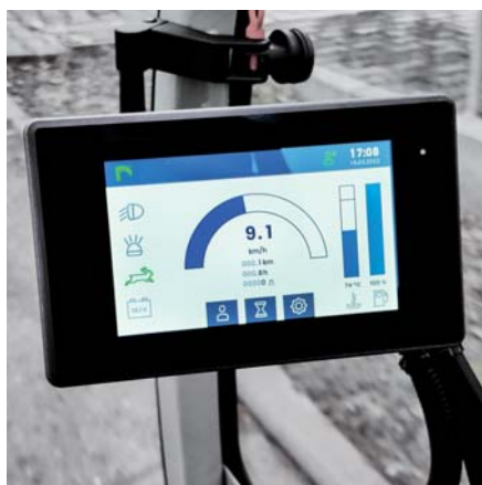
Scermo LCD a LED a colori per visualizzare i dati in tempo reale e la selezione di programmi automatici e profili di guida
