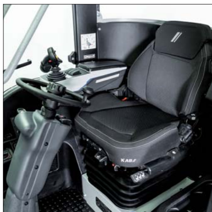
Cabina di guida disaccoppiata con sedile comfort a sospensione pneumatica sedile, riscaldamento del sedile e ammortizzazione longitudinale
