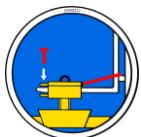
Pour établir une liaison sûre entre le chariot élévateur et la poche d'insertion (3), on introduit les dents du chariot élévateur (1) dans la poche d'insertion (3).
