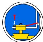
Um eine sichere Verbindung zwischen dem Gabelstapler und der Einstektasche (3) herzustellen, fährt man mit den Gabelstapler-Zinken (1) in die Einstektasche (3) hinein.
