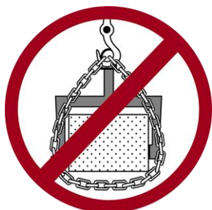
Łańcuch zabezpieczający ładunek (łańcuch mocujący) nie może być używany jako łańcuch zawiesia! Łańcuch zabezpieczający ładunek może się zerwać i ładunek spadnie!
