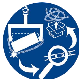
Jeżeli ładunek wpadnie na łańcuch zabezpieczający, należy go fachowo sprawdzić i w razie potrzeby wymienić.
