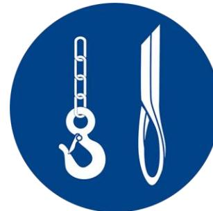
Erlaubte Anschlagmittel: Haken und Lasthebeband.
