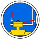
Um eine sichere Verbindung zwischen dem Gabelstapler und der Einstecktasche (3) herzustellen, fährt man mit den Gabelstapler-Zinken (1) in die Einstecktasche (3) hinein. Danach arretiert man diese entweder mittels Arretierungsschrauben (2), welche durch eine vorzusehende Bohrung in die Stapler-Zinken (1) gesteckt wird, oder mittels einer Kette oder eines Seils (4), das durch die Ösen an den Einstecktasche (3) und um den Gabelträger (↘) gelegt werden muss.
