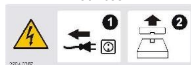
Warnung vor elektrischer Spannung Lebensgefahr! Vor Öffnen des Gehäuses, unbedingt vorher den Netzstecker von der Strom- versorgung abziehen 2904.0387
