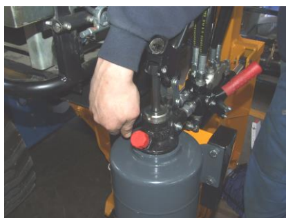
Mettre le levier de réglage de la pompe à main dans la position II
