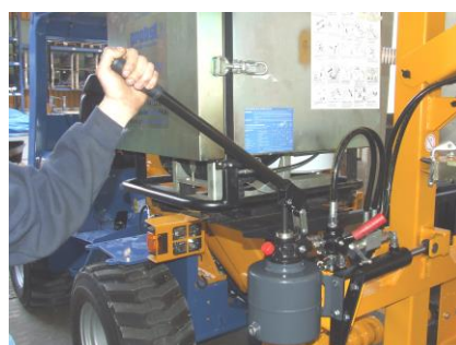
L'activation de la pompe à main redresse le mât.
