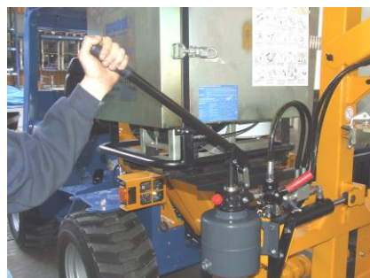
L'activation de la pompe à main abaisse le mât.
