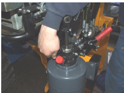
Mettre le levier de réglage de la pompe à main dans la position II
