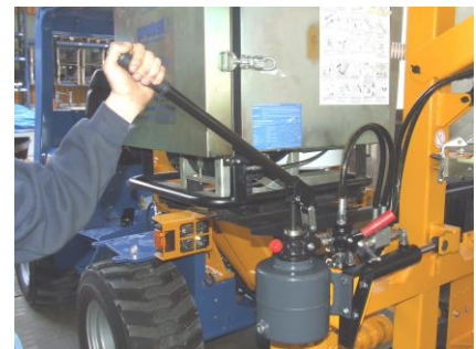
L'activation de la pompe à main déplace le mât vers la droite .
