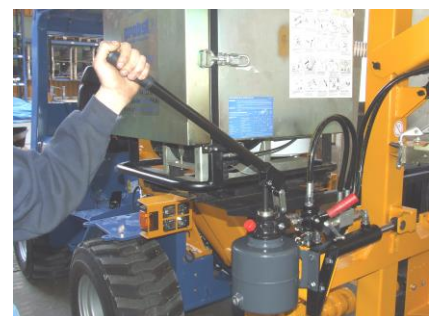
L'activation de la pompe à main déplace le mât vers la gauche .
