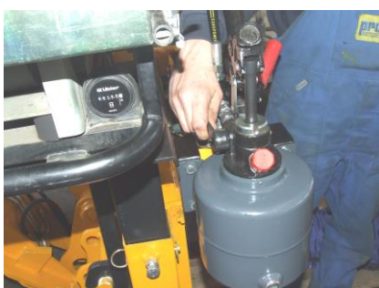
Mettre le levier de réglage de la pompe à main dans la position I
