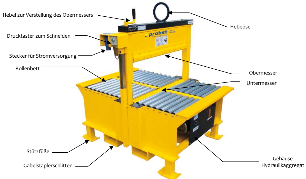
Abbildung 4.2-1: Aufbau der Maschine
