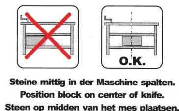
Abbildung 6.3-1: Piktogramm „Steine mittig in der Maschine spalten“
