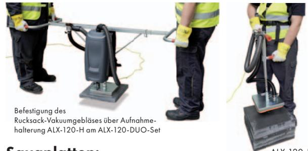
Befestigung des Rucksack-Vakuumgebläses über Aufnahmehalterung ALX-120-H am ALX-120-DUO-Set
