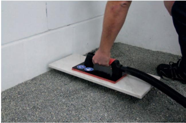
Das praktische Vakuum-Handverlegegerät ermöglicht das einfache, schnelle Heben, Versetzen und Verlegen von großen Fliesen, Natursteinen und Platten mit einer Hand.
