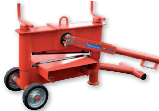
Steine knacken mit enormer Spaltkraft bei minimaler Betätigungskraft.
