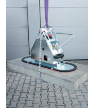
Handlich, kraftvoll, Akkuantrieb – zur Verlegung von saugdichten Steinplatten und Betonelementen bis 600 kg.
