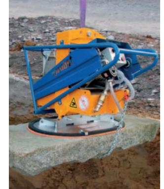
Leistungsstark mit Akkuantrieb. Für überwiegend saugdichte Beton- und Natursteinelemente bis 2.500 kg.
