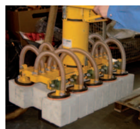
沟槽制品所用的多吸盘式铺装工具
