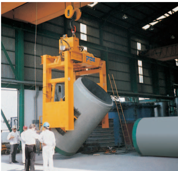
龙门吊用旋转式管道抱夹装置 PWG-R
