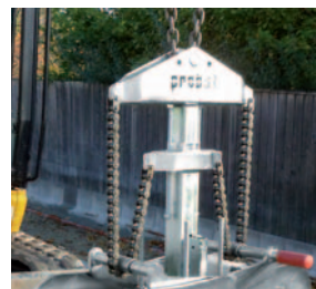
预制品夹具 FTZ-MULTI-15-D-WB-G-42
