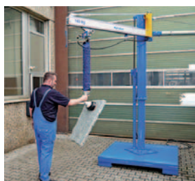
VACUSPEED VXS 软管式真空吊具
