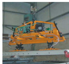
龙门吊用带横梁的真空吸盘 VT-6000-D
