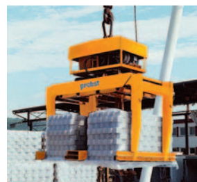
安装在龙门架上的双体式夹具 STAZ-DZ-I
