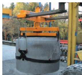
机械带式抓取装置 MBG
