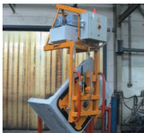
带180度旋转装置的真空提升器
