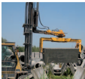
用于混凝土制品的叉车式抱夹 STAZ
