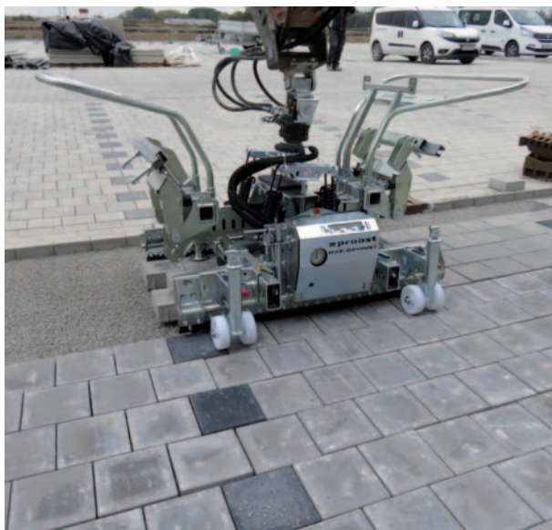
与挖掘机通用型液压铺装夹具 HVZ-GENIUS-II
