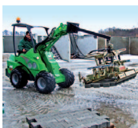
小型装载机上的液压铺装夹具
