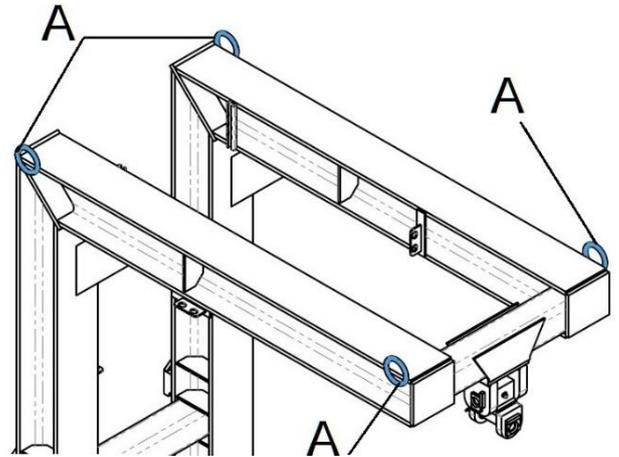
Um den Kranausleger am Gabelstapler zu montieren, positioniert man das Hubschild ① des Gabelstaplers unter die oberen Befestigungspratzen ② des Kranauslegers und befestigt anschließend die unteren Befestigungspratzen ③ am Hubschild ①, mit den beiliegenden Befestigungsschrauben.
