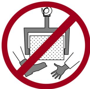
No sujete las extremidades bajo la carga levantada.
