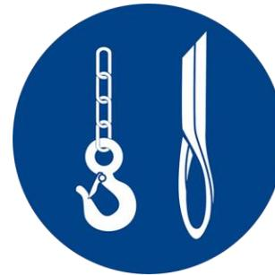
Erlaubte Anschlagmittel: Haken und Lasthebeband.
