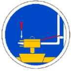
Um eine Verbindung zwischen dem Gabelstapler und der Einstecktasche herzustellen, fährt man mit den Gabelstapler-Zinken in die Einstecktasche hinein.
