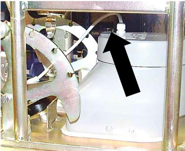
23. Das Ansaugen der Last (Steinplatte) erfolgt über den Kabelstecker (mit integriertem EIN/AUS-Schalter) am Handgriff (↓).
