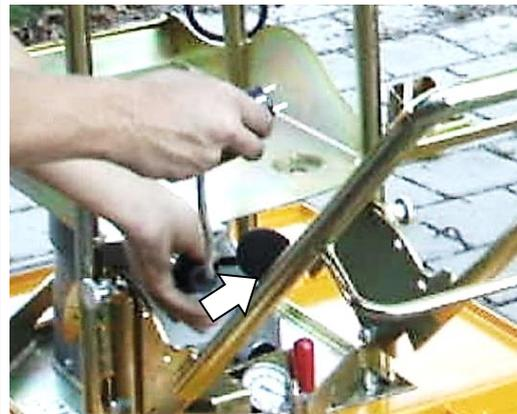
3. Anschließend Steckdose an Klemmbügel (vor Gebläseeinheit) befestigen (7).
