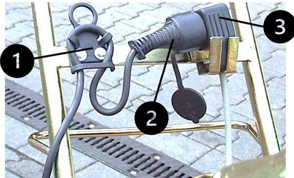
2. Stromkabel (3) von Gebläseeinheit kommend aus der Halterung am Handgriff entnehmen (7).
