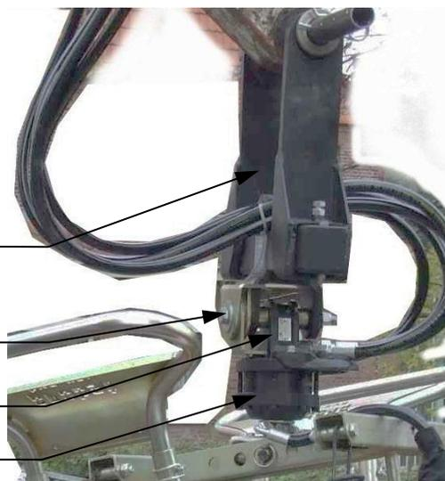
\*Einstellung der Sicherungsmutter hat Einfluss auf die Bewegungsgeschwindigkeit der Pendelbremse.
