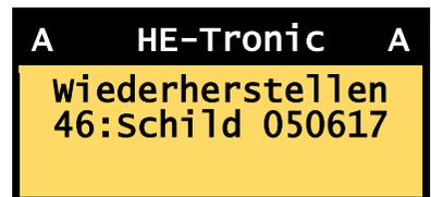
Wählen Sie dazu einen der 46 vorhandenen Datensätze aus und bestätigen diesen. Eine Kopie von diesem Datensatz wird in den Arbeitsspeicher geladen. Die Daten im Arbeitsspeicher bleiben auch erhalten, wenn die Anlage ausgeschaltet wird. Die Datensätze werden i.d.R. nach Installation, Einrichtung und Kalibration des UMC 4000-Systems für das jeweilige Planierschild abgespeichert.
