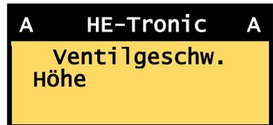
Für die Arbeitsgeschwindigkeit kann ein Wert zwischen 1% und 100% eingestellt werden.
