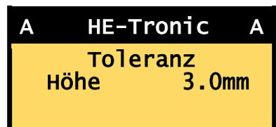
Die Toleranz kann zwischen 0,5 mm und 50 mm eingestellt werden. Wird ein Wert von 10 mm eingestellt, darf sich die Schneidkante innerhalb von  $\pm 5$  mm bewegen.
