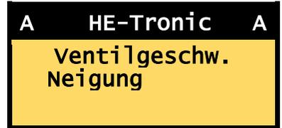
Für die Arbeitsgeschwindigkeit kann jetzt ein Wert zwischen 1% und 100% eingestellt werden.
