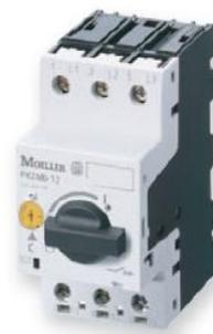
Cuando se utiliza un soplador de vacío o una bomba de vacío, se utiliza un disyuntor de protección del motor. El disyuntor de protección del motor sirve para desconectar el generador de vacío y protegerlo al mismo tiempo. El disyuntor de protección del motor está adaptado al generador de vacío conectado. No se debe conectar ningún otro consumidor a la salida del interruptor automático.
