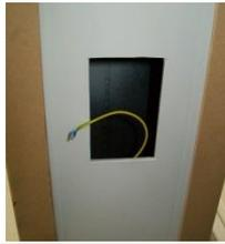
1. Fije el cable de puesta a tierra al interior de la columna de la grúa utilizando las arandelas y la tuerca suministradas con la columna de la grúa.
