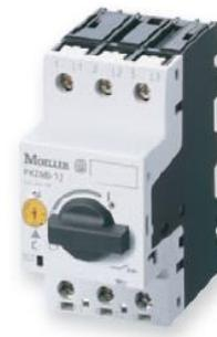
Ein Motorschutzschalter kommt zum Einsatz, sobald ein Vakuumbelüfter bzw. eine Vakuumpumpe eingesetzt wird. Der Motorschutzschalter dient zum Abschalten des Vakuumerzeugers und schützt diesen gleichzeitig. Der Motorschutzschalter ist auf die angeschlossene Vakuumerzeugung abgestimmt. Es dürfen keine weiteren Verbraucher an den Abgang des Motorschutzschalters angeschlossen werden!
