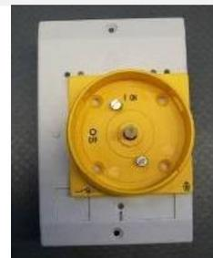
2. Die Blende des Einbaurahmens an den Schalter anschrauben. Dies erfolgt über die gelbe Montageplatte des Hauptschalters. Verwendenden Sie dazu die markierten Löcher (2) in der Blende. Das Glöckner Möller Logo (1) dient als Orientierungshilfe.
