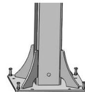
Disposition optimale pour plusieurs tôles d'appui empilées
