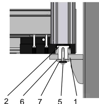
Introduisez le boulon supérieur (7) dans le perçage de la plaque d'appui supérieure (4) et dans le palier (8) du palier d'articulation. Vissez les vis de sécurité (9) avec des circlips Schnorr (10) et serrez avec une clé dynamométrique.
