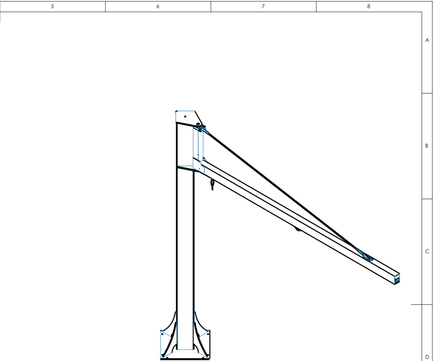
Tragfähigkeit 300 kg / load capacity 660 lb
