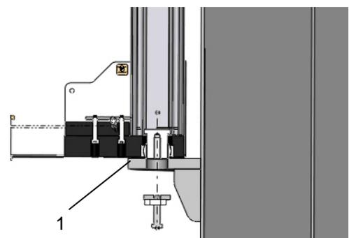
Extrayez le boulon (2) avec la vis (5), la rondelle (6) et le blocage anti-rotation (7) par le perçage de la plaque d'appui inférieure (1). Serrez la vis, une fois la flèche positionnée.
