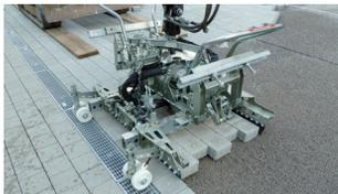
Leistungsfähige Anbauzange für den Minibagger: Nur ein hydraulischer Steuerkreis reicht aus, um sämtliche Bewegungsabläufe der Zange zu steuern.
