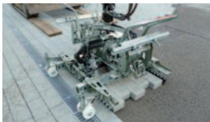
Pince de pose efficace pour mini-pelle : un seul circuit de commande hydraulique suffit pour contrôler toutes les séquences de mouvements de la pince.
