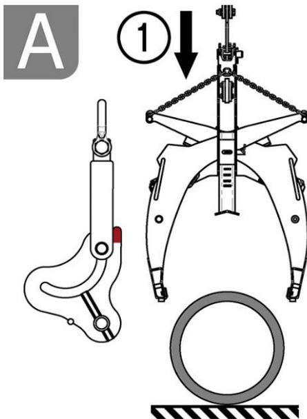
Gerät mit der Einhängeöse am Trägergerät/Hebezeug befestigen
