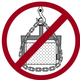
Lastsicherungskette (Zurrkette) darf nicht als Anschlagkette verwendet werden! Die Lastsicherungskette kann reißen und die Last würde abstürzen! Verletzungs- und Lebensgefahr!
