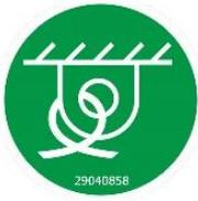
Occhiello di ancoraggio per fissare l'unità/macchina al veicolo di trasporto con catene o cinghie di tensione.
