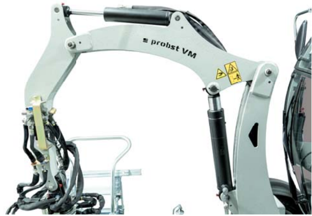
wariant premium: wysięgnik przegubowy zwiększający zasięg
