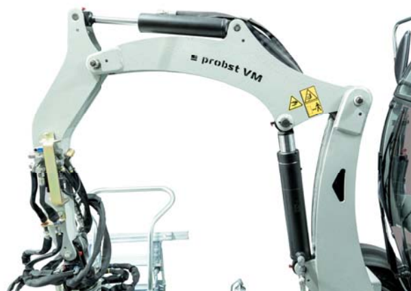
variante premium : la flèche articulée avec deux articulations augmente la portée
