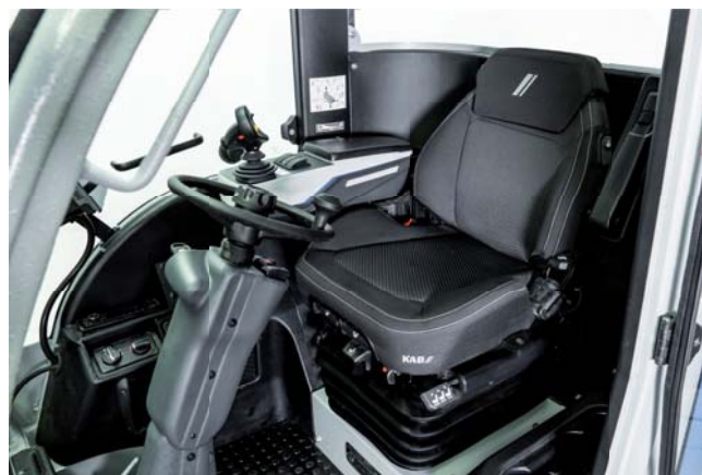
Cabine de conduite indépendante avec siège confortable à suspension pneumatique, chauffage du siège et amortissement longitudinal
