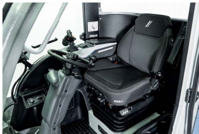
Cabina del conductor desacoplada con asiento confort con suspensión neumática, calefacción del asiento y amortiguación longitudinal
