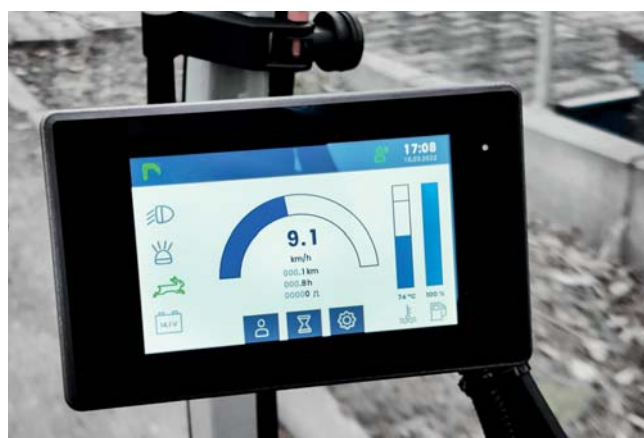
Pantalla táctil LCD LED en color con visualización de datos en tiempo real y para seleccionar programas automáticos, perfiles de conducción, ...
