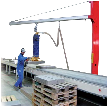
ASSK mit Hubeinheit, Bedieneinheit und Saugplatte
